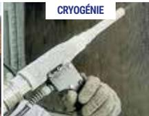
Nettoyage par Carboglace de vos supports délicats (graisse, bitume, laitance...)
